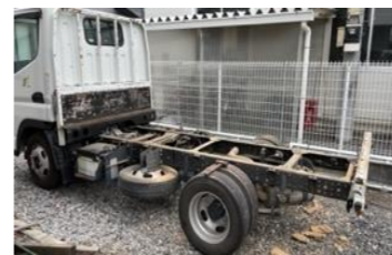
荷台を外した骨組みの様子
